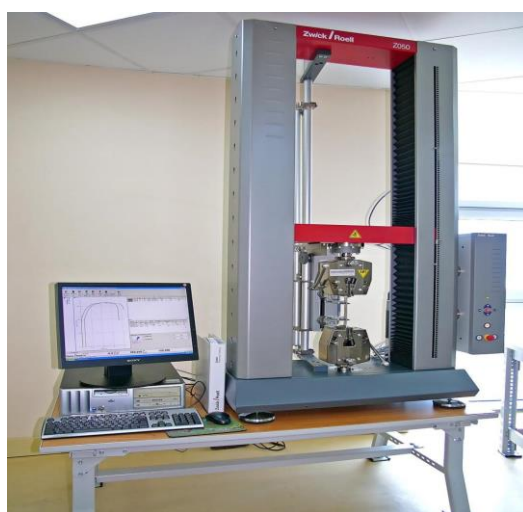
Equipo de Pruebas Mecánicas, para ensayos físicos o mecánicos marca Zwick/Roell modelo Z050, capacidad de 50 KN (50,000 N o 5 Toneladas)
